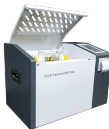
Prueba de rigidez dieléctrica (Espinterometro)
